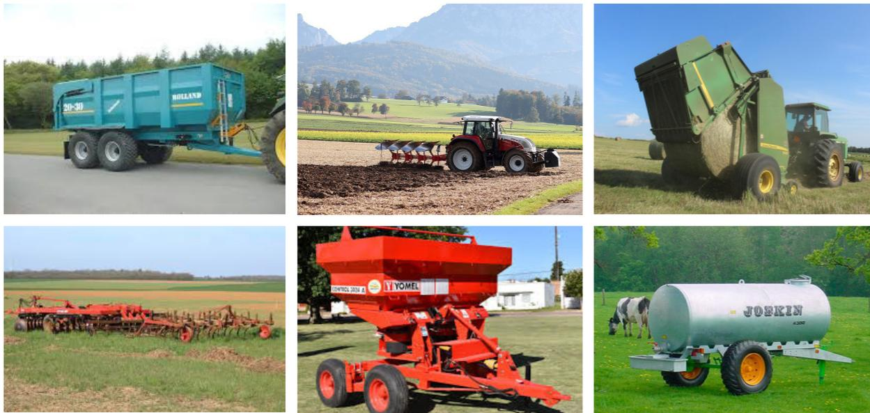
On attèle tous ces engins au tracteur en utilisant la prise de force qui est reliée au moteur ; la force du moteur passe dans cette prise et permet d'actionner les machines attelées.
